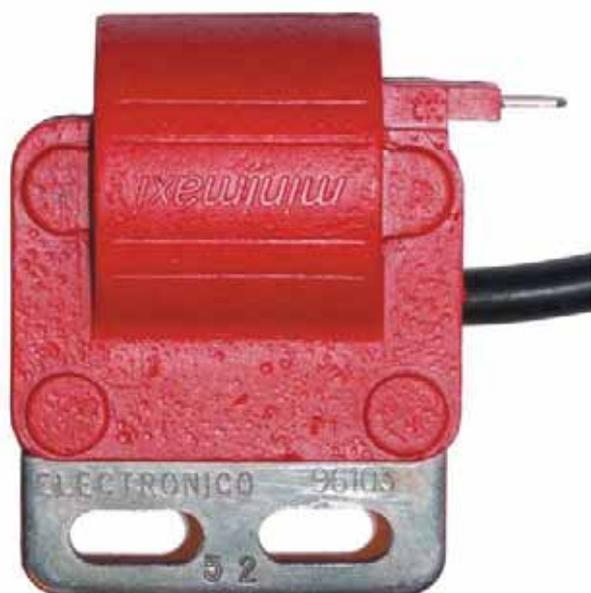
Bobina de alta tensión electrónica para encendidos con CDI's Motoplat rojos y negros. Se empareja con los cdi's CD12, CD13, CD14, CD15 y CD16 de Levistic. Véanse los manuales de taller.
