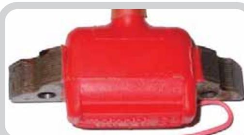
Forma original de la bobina sustituida
