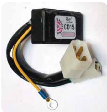
Cdi de avance variable ref. CD15 "Negativ". El calado coincidirá exactamente con el orificio entre estator y rotor, y misma curva de avance, para un motor que gire en sentido contrario al indicado en el rotor.
